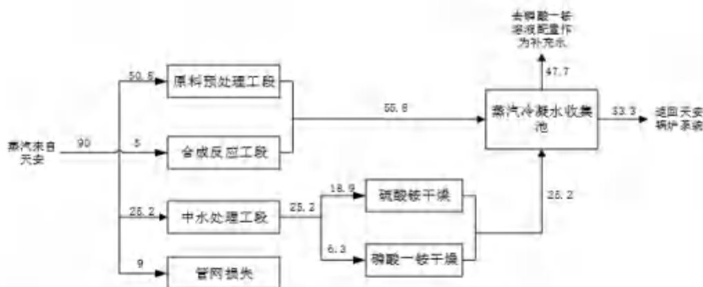
图 2.3-1 项目蒸汽平衡图（单位：t/h）
